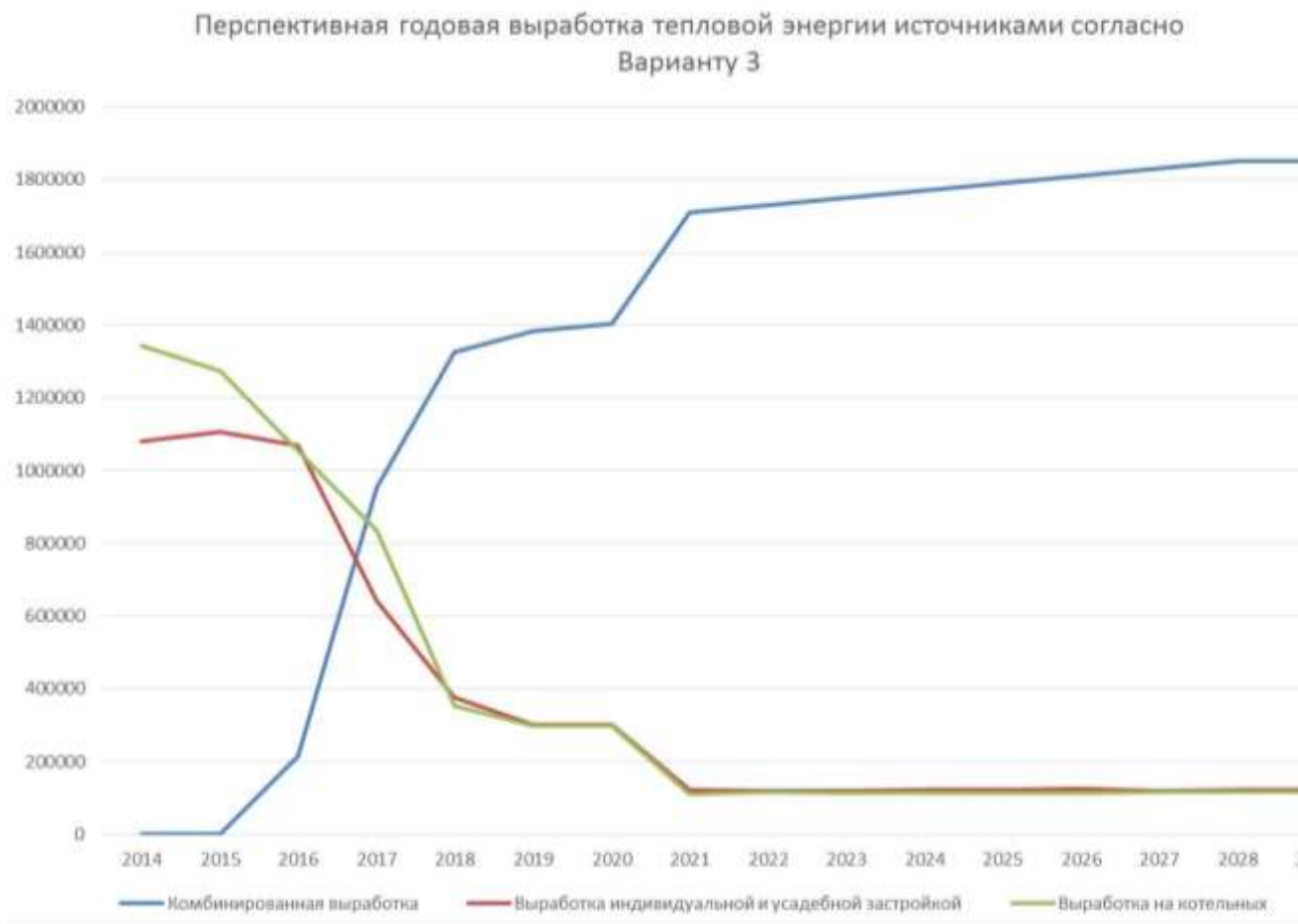
Рисунок 2.1.3.1 – Перспективная годовая выработка тепловой энергии источниками согласно Варианту 3 (Гкал/год)
