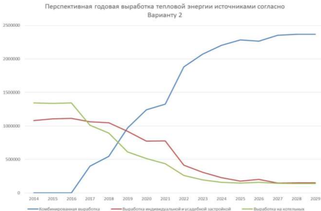
Рисунок 8.1.2.2 - Перспективная годовая выработка тепловой энергии источниками согласно Варианту 2 (Гкал)
